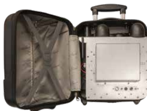
Brama PIK-GAT w wykonaniu przenośnym kamuflowanym, przeznaczonym dla patroli pieszych i załóg niewyposażonych w bramy pojazdowe
